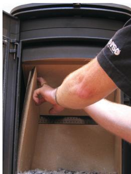
2. Kantel een van de stenen zijplaten en verwijder hem.
