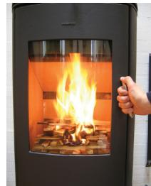
5. Si les conditions du point 4 sont remplies, mettre au maximum 3 bûches d'un poids total de 1,5 à 2,5 kg et d'une longueur de 25 à 30 cm à plat sur les braises, avec un espace d'env. 1 cm entre les bûches.
