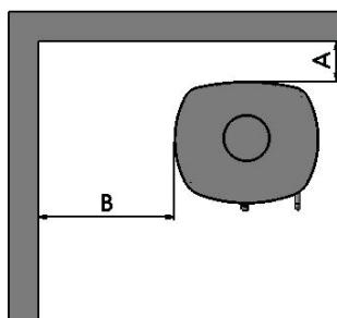
Compte tenu de la circulation de la chaleur, du nettoyage et éventuellement du nettoyage de l'intérieur du poêle, le dégagement recommandé depuis le mur est de 10 à 15 cm. La tapisserie posée sur les murs n'est normalement pas considérée comme matériau inflammable.
