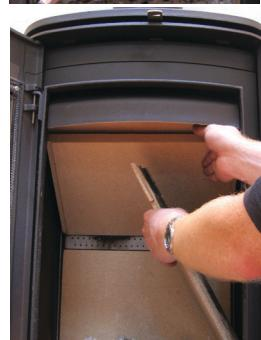
4. Nadat de stenen zijplaten verwijderd zijn, schuift u het onderste rookschot naar beneden en verwijdert u het.
