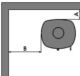
Met het oog op de warmtecirculatie en de interne en externe reiniging van de kachel raden wij u aan de kachel op ten minste 10 à 15 cm afstand van metselwerk te plaatsen. Normaal gesproken wordt een laag behang op een stenen wand als niet-brandbaar materiaal beschouwd.
