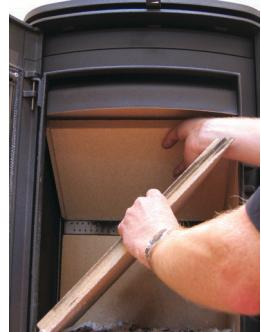
3. Kantel de tweede stenen zijplaat en verwijder hem.
