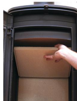
5. Lever et sortir de son support la chicane pour la fumée supérieure et la basculer pour la sortir.
